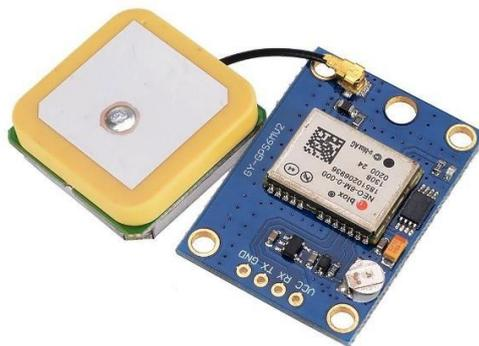
Fig.7. GPS Sensor Module
